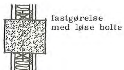
Udfyldning med træskelet med beklædning.
