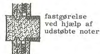
Udfyldning med jernbetonelementer
