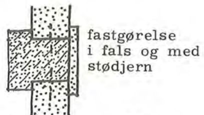
Udfyldning med letbetonblokke.
