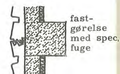
Udfyldning med metalplader.
